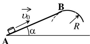
Небольшая шайба после удара скользит вверх по наклонной плоскости из точки А (см. рисунок). В точке В наклонная плоскость без излома переходит в наружную поверхность горизонтальной трубы радиусом  $R$ . Если в точке А скорость шайбы превосходит  $v_0 = 4$  м/с, то в точке В шайба отрывается от опоры. Длина наклонной плоскости  $AB = L = 1$  м, угол  $\alpha = 30^\circ$ . Коэффициент трения между наклонной плоскостью и шайбой  $\mu = 0,2$ . Найдите внешний радиус трубы  $R$ .
